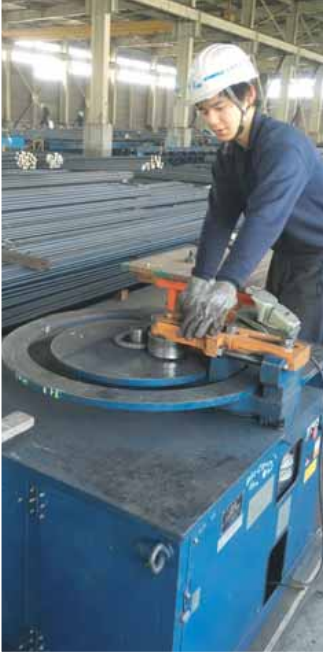
5 主組立て・帯筋巻きで、カゴ状柱組立て
